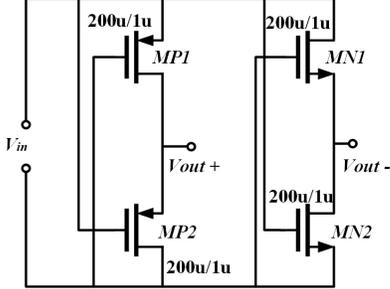
Fig. 2. Fully cross-coupled rectifier.
