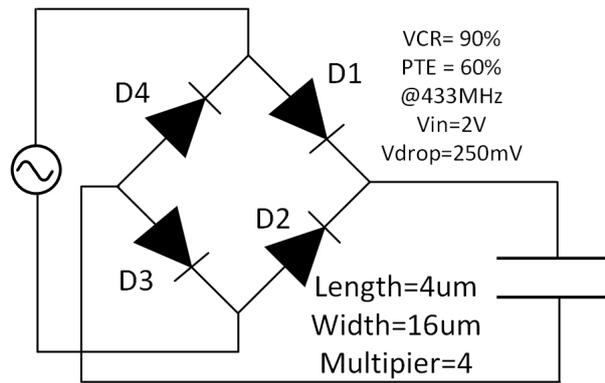
Figure 4.7: Shottky diode rectifier.
